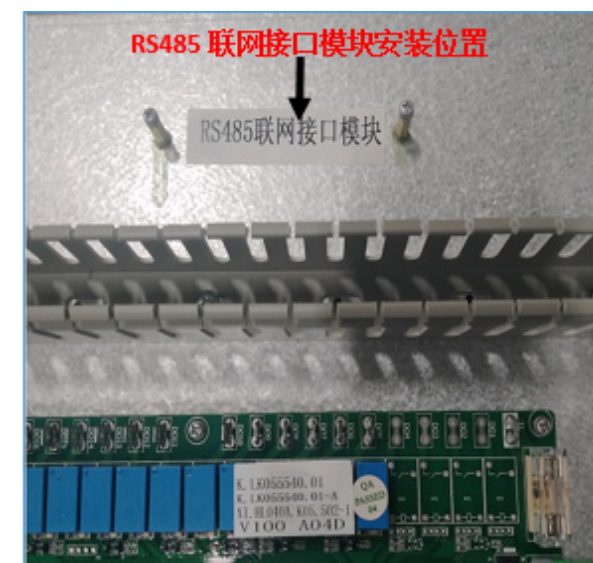
图11 RS485 联网接口模块安装位置图
