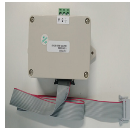
图 27 RS485 联网接口模块及其连接排线
