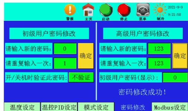
输入两次相同密码（例如：123）后，按“确定”按键，跳出提示“密码修改成功”，如左图所示，代表用户密码修改成功，以后会以新的密码（123）为准。
