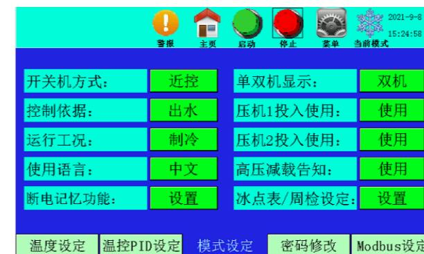
开关机方式：近控 / 远控 / 监控 / 定时
