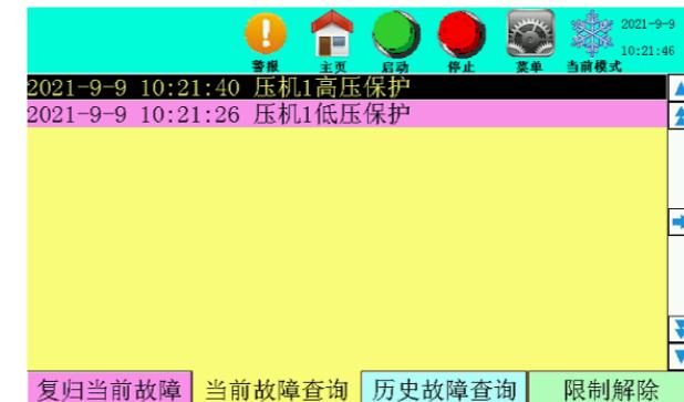
单击“快捷菜单”中 按键，或在机组发生故障时自动跳转，均可进入“当前故障查询”界面，显示当前故障信息，如左图。当物理故障得到恢复后，单击“复归当前故障”键，即可完成手动复归当前故障。
