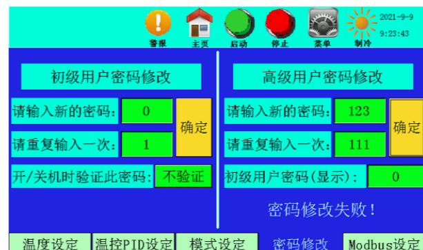
输入两次密码不相同时，按“确定”按键后，跳出提示“密码修改失败”，如左图所示，代表用户密码修改失败，仍为原密码。当然可以继续修改（无输错锁定限制）。
