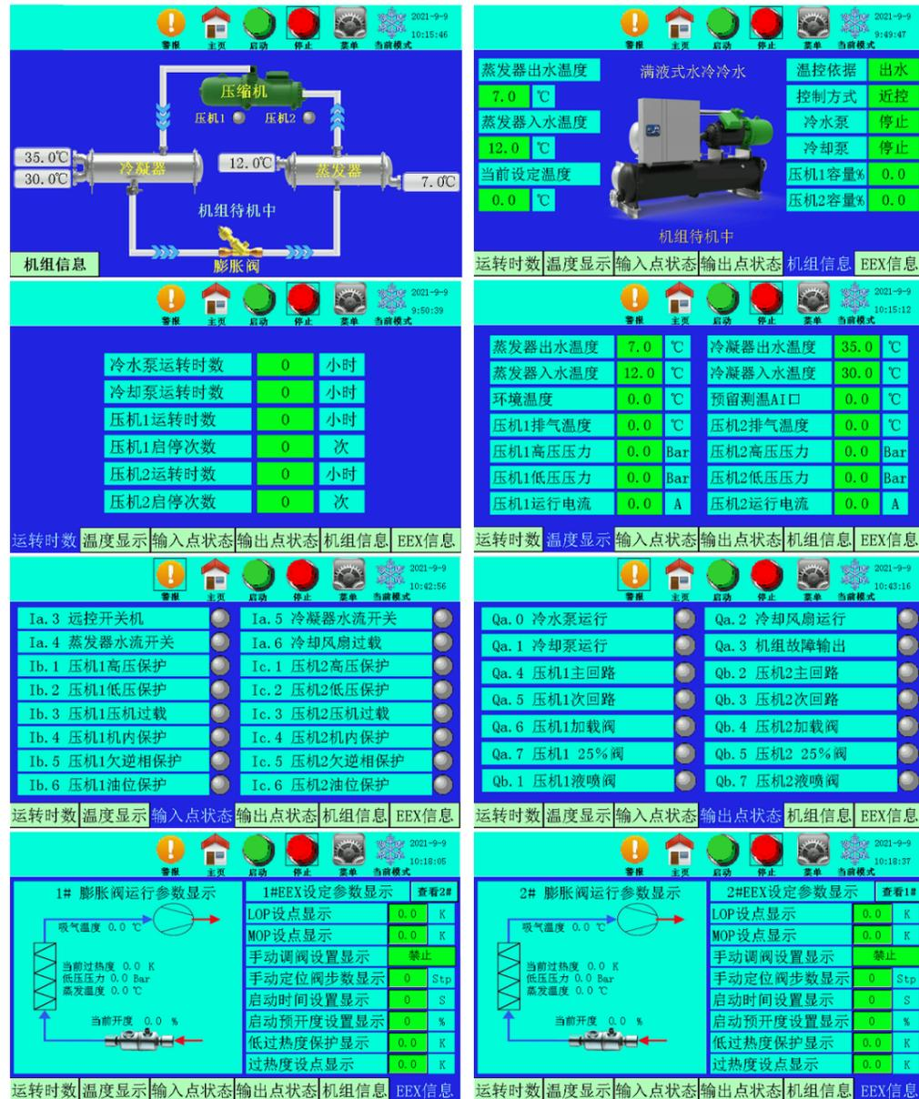
注：输入点状态界面中，灰色灯表示为接点处于断开状态，绿灯表示为接点处于导通状态；
