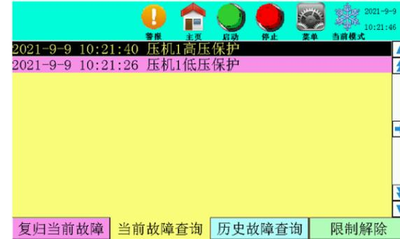
单击“快捷菜单”中 按键，或在机组发生故障时自动跳转，均可进入“当前故障查询”界面，显示当前故障信息，如左图。
