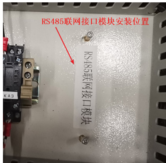
图 6 RS485 联网接口模块安装位置图
