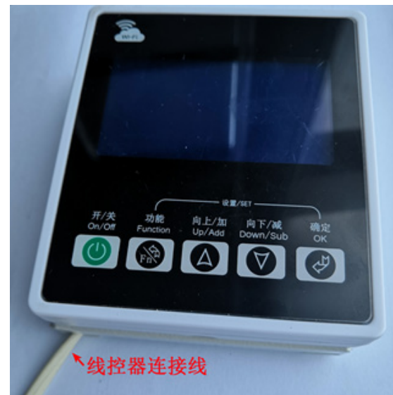
图 16 线控器安装图
