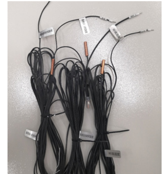
图 20 环境 / 系统蒸发侧 / 系统冷凝侧温度传感器
